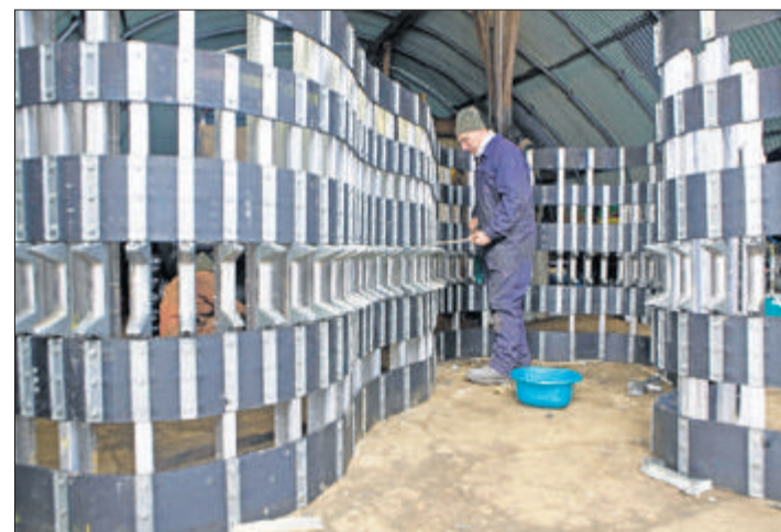
A l'atelier , Didier Colin s'attelle à la réparation d'une chenille endommagée par un caillou. «Si près de l'ouverture de la station, immobiliser ainsi un rattrac est assez problématique», avoue Joël Cretin.
